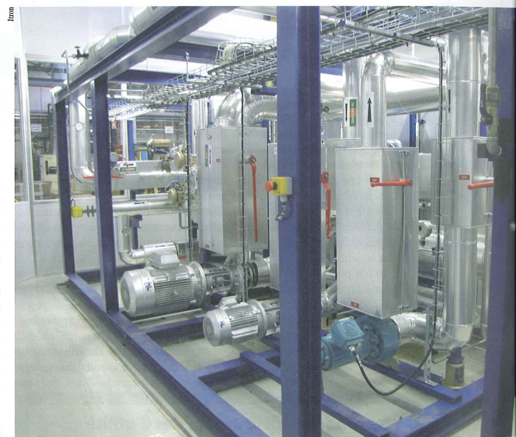
Le banc d'essai développé par Coretec et Mesure et Simulation industrielle (MSI) pour la société Itron ne passe pas inaperçu. Il est en effet capable de valider des compteurs d'eau de diamètres jusqu'à DN150 et de débits maximums ou maxima de 220 m 3 /h.
