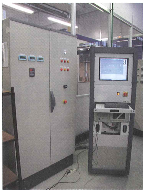
Le banc d'essai des compteurs d'eau ne serait pas grand-chose sans sa baie 19 pouces intégrant un PC industriel, les câblages d'instrumentation ainsi qu'un châssis PXI dans lequel tourne l'application de régulation.
